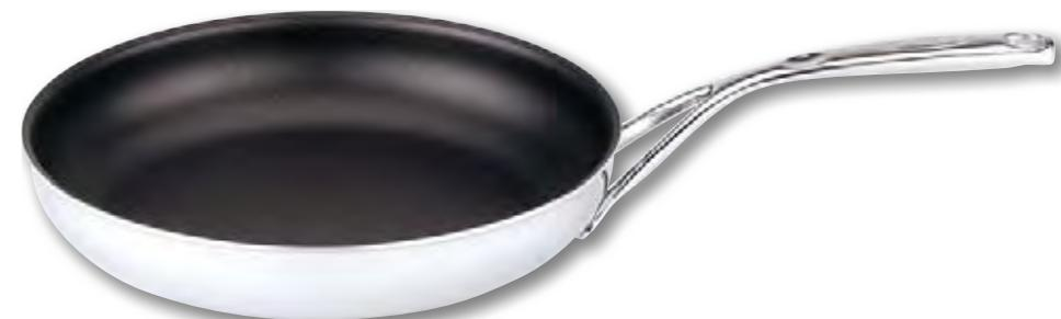
El sistema Controlinduc® impide que la temperatura máxima sobrepase los 250°C sobre las cocinas de inducción. Incluso con máxima potencia, la sartén ajusta la temperatura sin intervención del usuario impidiendo el sobrecalentamiento. El Teflón, utilizado en todos los tipos de capas antiadherentes, se deteriora más allá de 280° y pierde sus propiedades antiadherentes. Este sistema evita estos riesgos, pero únicamente en placas de inducción. ¡Se acabó el Sobrecalentamiento!
