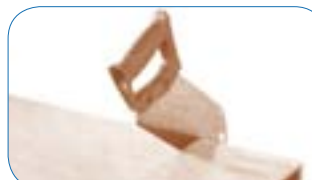
A medida. Recortable con un sierra de dientes finos.
